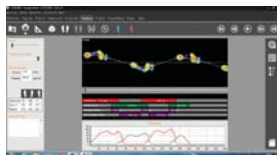
Figuur 47: Het tabblad "Analyse" bij de meerdere dynamische meting. Alle resultaten zijn te zien, het drukbeeld is in verschillende illustraties zichtbaar. De resultaten kunnen in dit tabblad worden geprint. Het drukbeeld kan ook worden afgespeeld.
