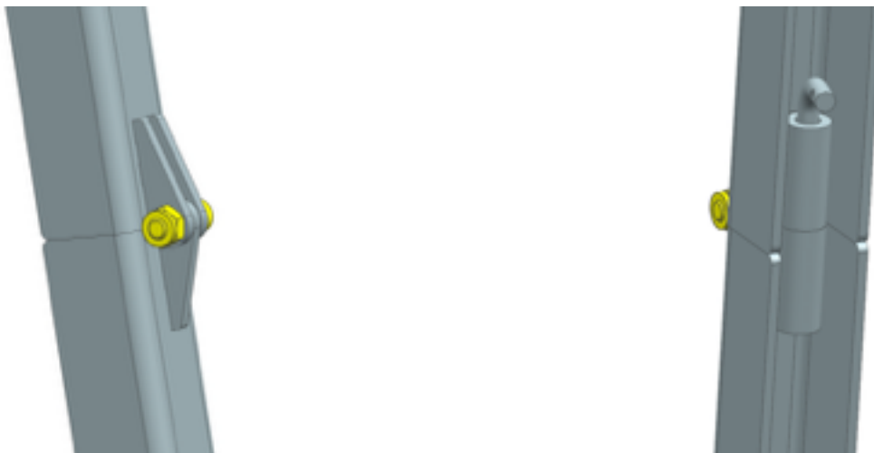
Figuur 7: Scharniergeedeelte van V-vormige constructie (links), scharnier blokkering (rechts)
