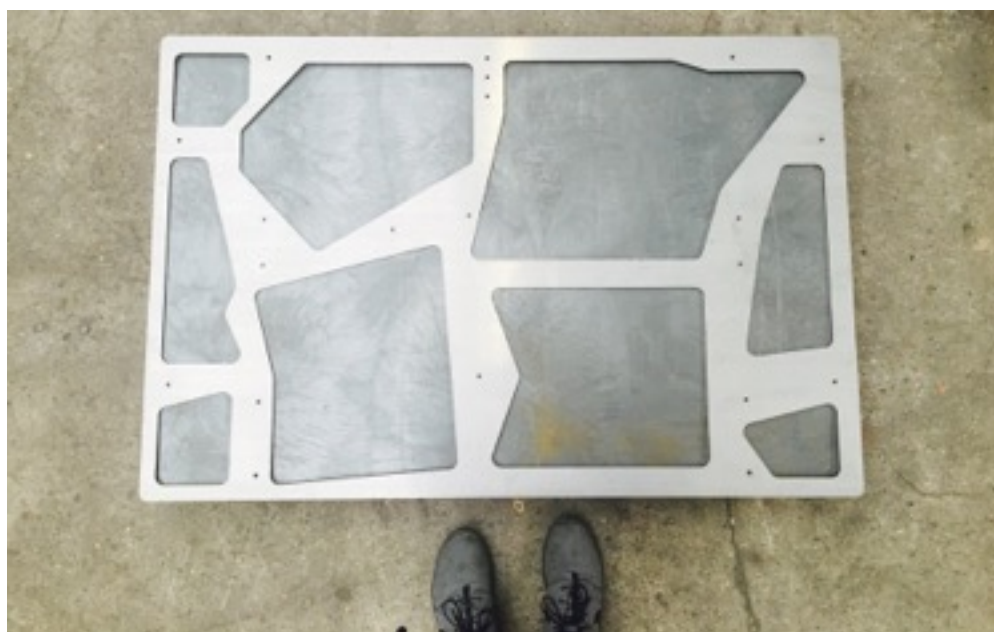
Figuur 16: Foto van de boormal, om de gaten op de juiste plaats in de pallets te boren.
