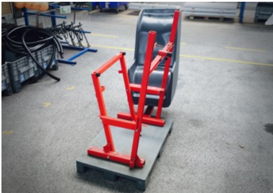
Figuur 2: Het oude transportrek met de iXter B schoonwatertank nog in de houder.
