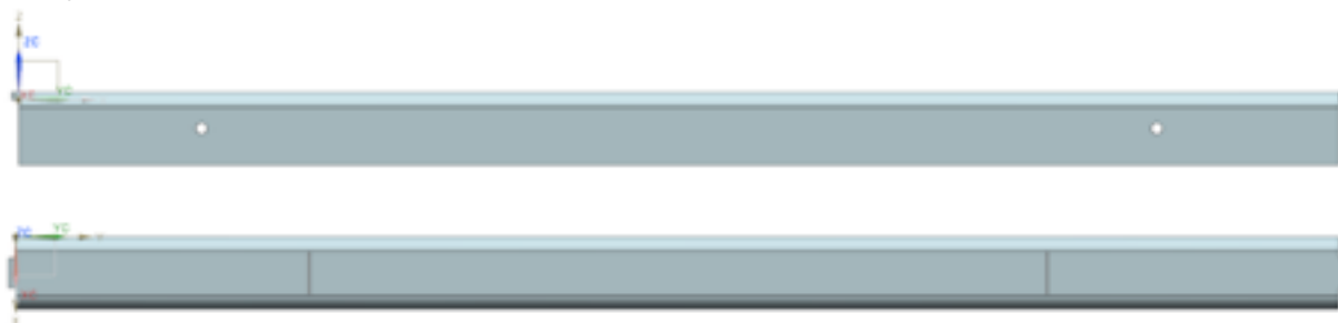
Figuur 14: Symmetrisch onderdeel, dit onderdeel kan op twee manieren worden gemonteerd.
