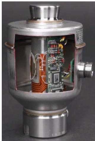
1.2-a Load cell cutaway [1]
