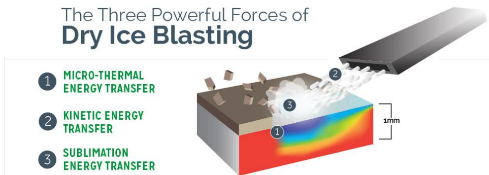
Afbeelding 1.5: Werking droogijs reinigen (Polarclean, z.j.)
