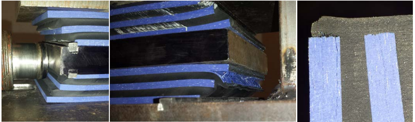
Afbeelding 4.8, oplegblok tijdens(1&2) en na afschuifproef(3)
