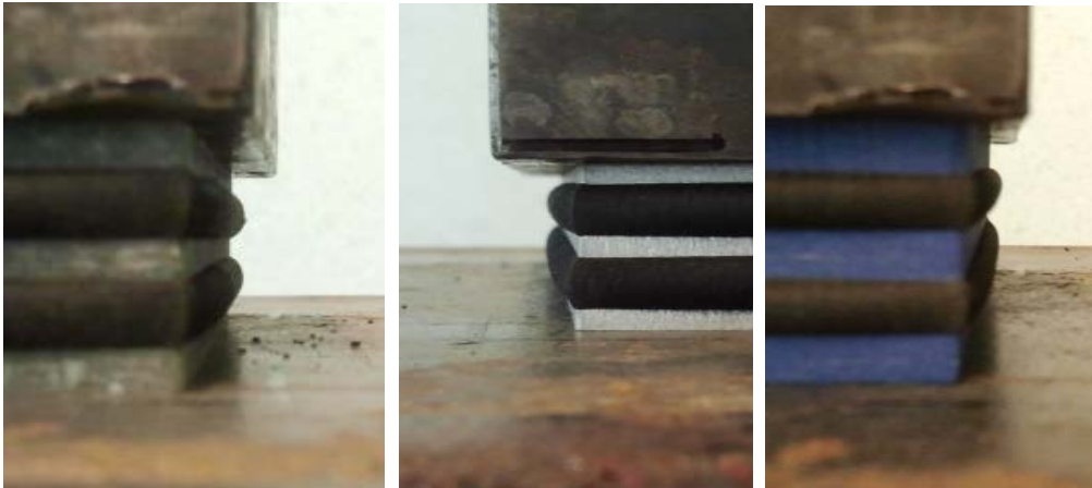
Afbeelding 4.2, uitbollend rubber bij drukproef
