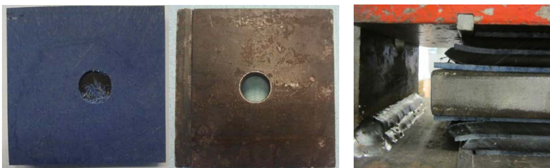
Afbeelding 4.7, gaten in dunne blauwe wapeningsplaat(1 & 2) en loslatend rubber aan de rand(3).
