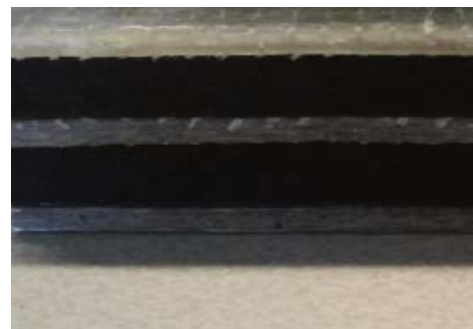
Afbeelding 3.1, opbouw composiet oplegblok
