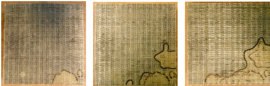
Afbeelding 4.1, bezwijken massief rubber en epoxy oplegblok na 1x, 2x en 3x belasten
