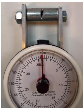
Figuur 101 Aangepaste krachtmeter voor testen
