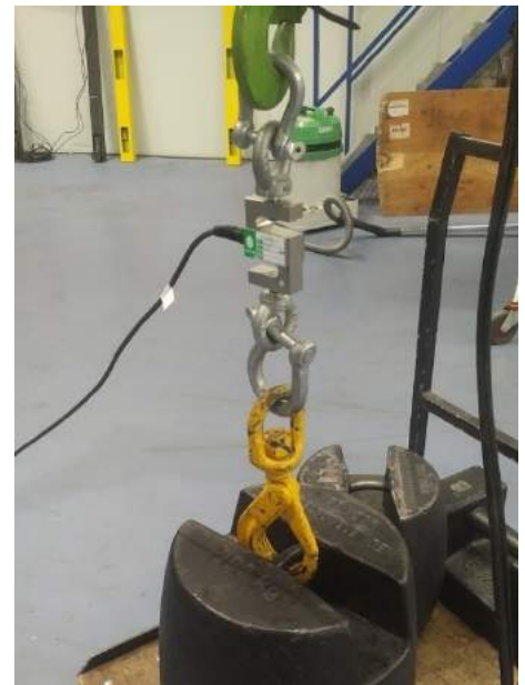
Afbeelding 23: Opstelling voor validatie van de S-beam load cell.
