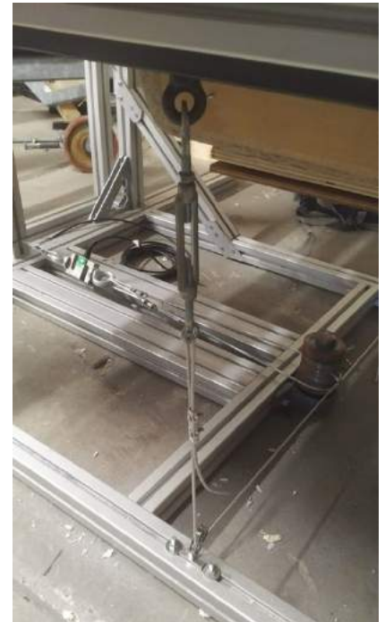
Afbeelding 32: Bevestiging van het staaldraad aan de boot en de sensor.
