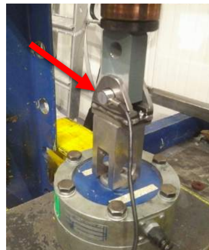
Afbeelding 19: Stensit load sensing pin (aangegeven met de rode pijl) ingeklemd in een hydraulische pers.
