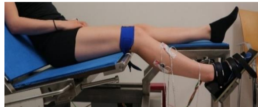
Figuur 2. De proefpersonen zaten in een verstelbare stoel waarbij de voet met een voetplaat aangesloten was op een actuator. De knie was ingesteld op 20^\circ flexie en werd gefixeerd met een band. De actuator bracht rotaties van de voetplaat aan met verschillende snelheden. Met een dynamometer ingebouwd in de motor werden de reacties van de structuren rond het enkelgewricht op deze rotaties gemeten.
