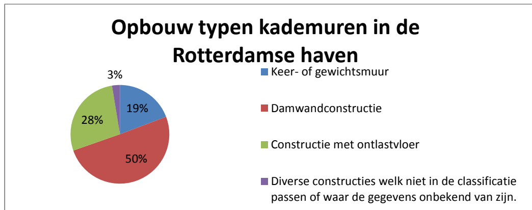
Figuur 4: Verdeling van de typen kademuurconstructies in beheer van het Havenbedrijf Rotterdam.
