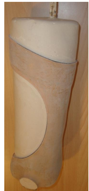
Figuur 5.6 Koker volgestort met gips voor de tweede gieting
