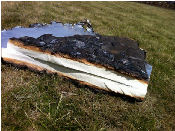
Figuur 13. Verkoolde PIR platen na een brand. (32)
