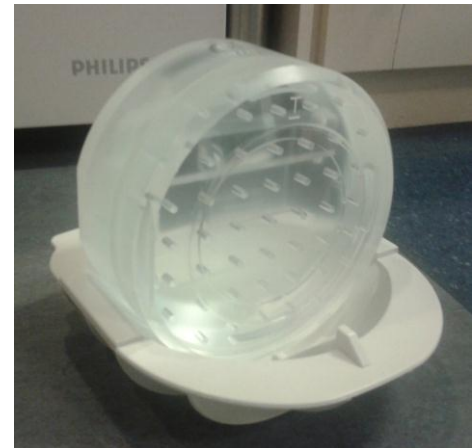
Figuur 1: afbeelding van het '200mm performance phantom' van Philips in de bijbehorende houder
