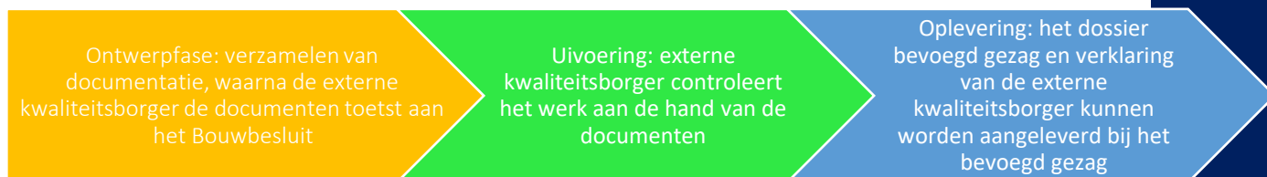
Figuur 11: beknopt fasen in de bouw met bijbehorende activiteiten na ingang van de Wet kwaliteitsborging (J. van Heeswijk, z.d.)
