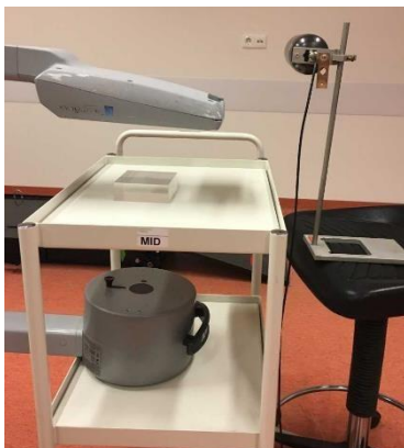
Figuur 6 A) Buisgeometrie 2 verticaal met röntgenbuis aan de onderzijde. B) Meetpunten.
