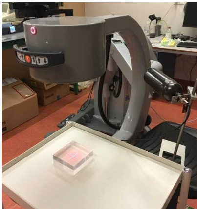
Figuur 5 A) Buisgeometrie 1 verticaal met röntgenbuis aan de bovenzijde. B) Meetpunten.
