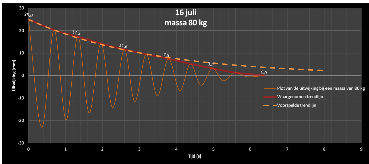
Figuur 17 Voorspelde trendlijn op basis van eerste meting
