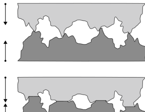
Figuur II-1 Vervorming van asperity door toevoegen van druk (TotoBaggins)
