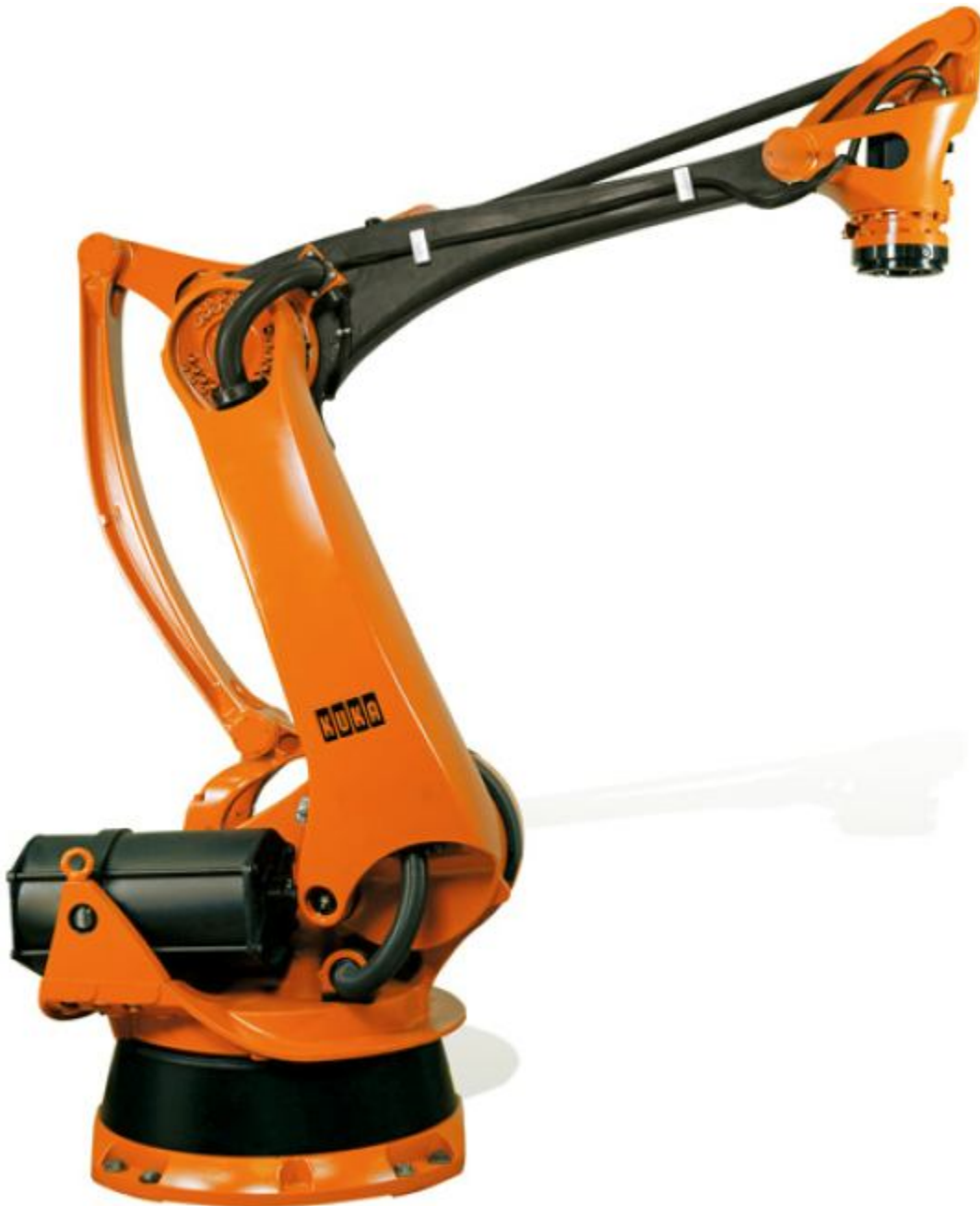
Kuka KR100 2A robot, geproduceerd uit koolstof composiet
